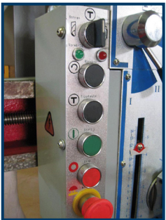
автом. резьбонарезное приспособление и центральная панель управления
